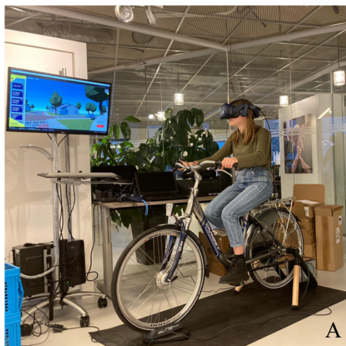
Figuur 1a: In deze afbeelding is de opstelling van het experiment te zien. Waarbij de fiets in een standaard zit en de participant de VR-bril draagt.
