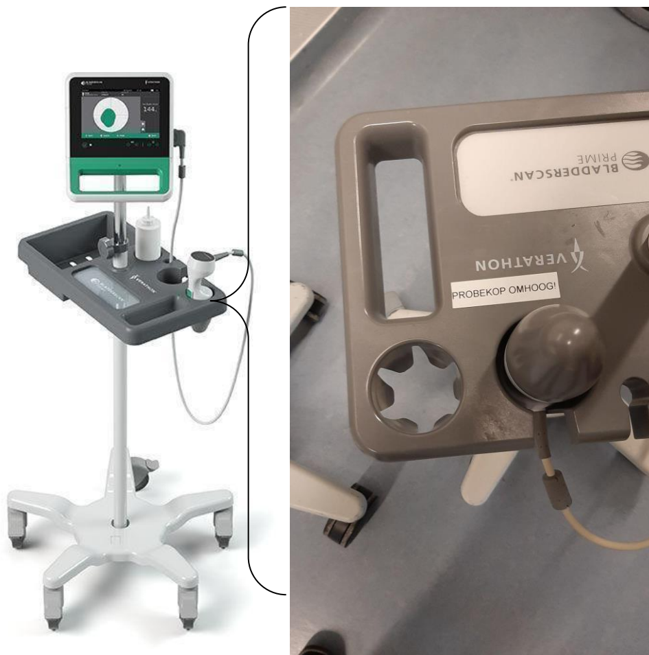
Afbeelding 1: een sticker op een bladderscan in het UMCG. Deze geeft aan dat de probekop op de correcte manier in de houder moet worden geplaatst, anders gaat deze bij verplaatsing van de bladderscan stuk.
